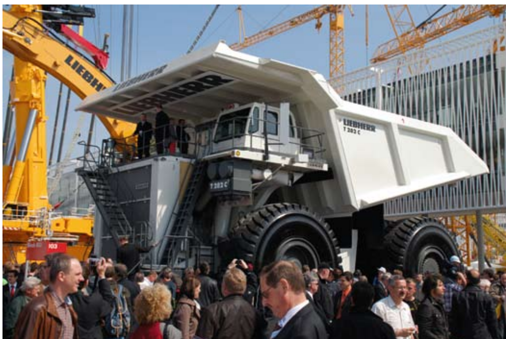
De Liebherr T 282 C dumper stal de show, met een eigen gewicht van 237 ton en een motorvermogen van 3755 pk.
